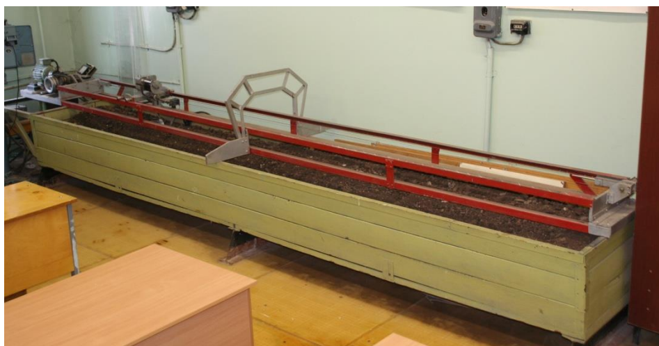
Рис. 5.4. Лабораторный почвенный канал
