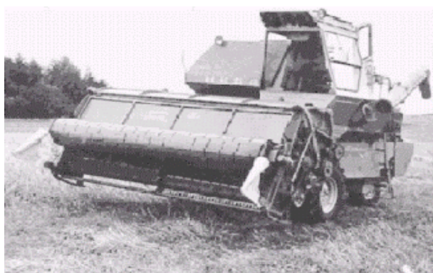
Рис. ПЗ-2. Очесывающая устройство к комбайну СК-5 "Нива"
